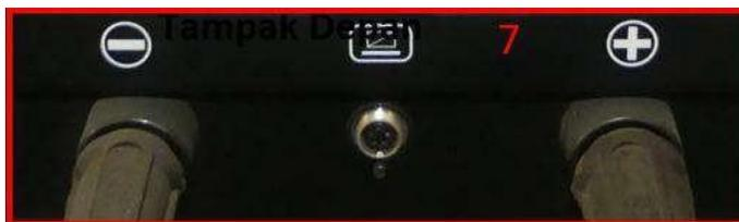
+ : Kutub positif menyambung dengan elektroda.
